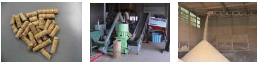
木質ペレット 民間企業による取組 高圧成形 間伐材破砕 那須塩原市内
