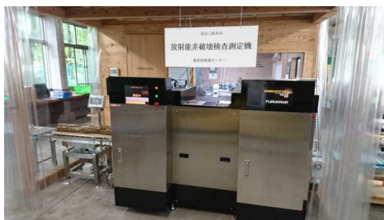
きのこ原木用放射能の非破壊検査測定機 古河機械金属(株)製ガンマスポットター FG5F-TF (GAMMA RADIATION DETECTOR FG5F-TF)
