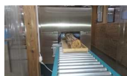
きのこ原木用放射能の非破壊検査測定機 古河機械金属(株)製ガンマスポットター FG5F-TF (GAMMA RADIATION DETECTOR FG5F-TF)
