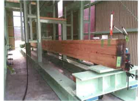
自主研究(クリープ試験) ～スギ・ヒノキの長期性能の解明～
