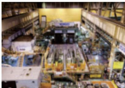
高品質、高生産性を誇る6段2タンデム冷間圧延機
