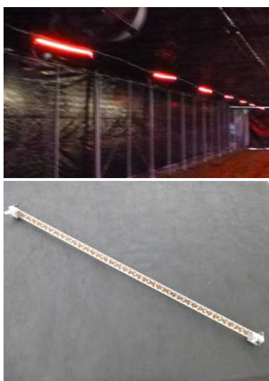
図 2 改良した赤色LED電照装置(下)とほ場設置状況(上)
