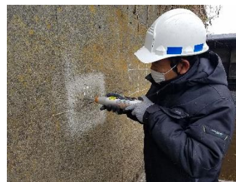
コンクリートの強度試験の様子
