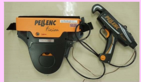
写真1 誘引結束機（バッテリー駆動式）
