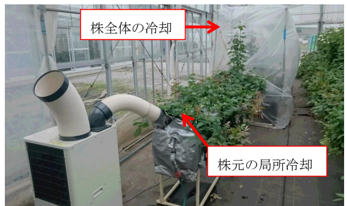
図 スポットクーラーを利用した冷却試験の様子
