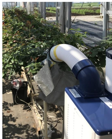
写真 スポットクーラーを利用した試験の様子
