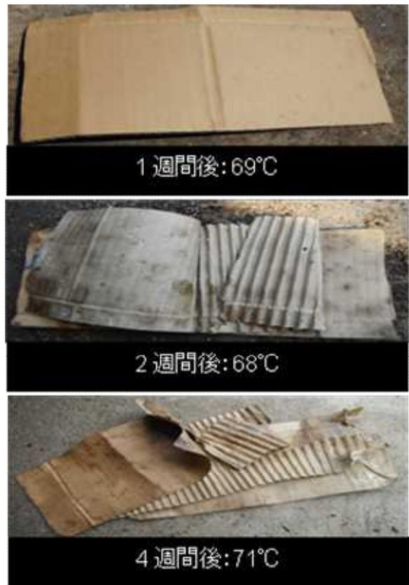
図8 堆肥中の温度及び段ボールの変化
