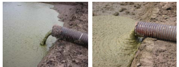
図4 投入スラリーの季節変動 左図：夏期搬出スラリー(水分89%、粘度380cp) 右図：冬期搬出スラリー(水分87%、粘度1280cp)
