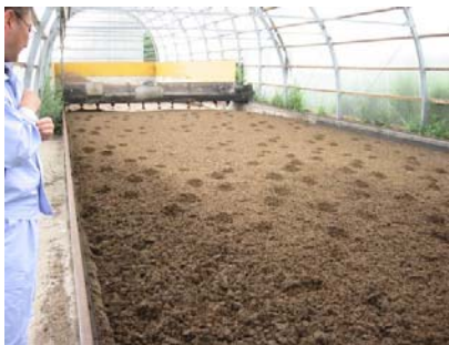
図5 浅型攪拌施設最終部
