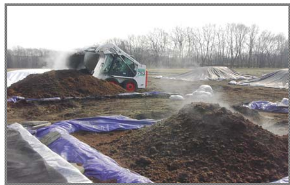
図12 重機による切り返し作業
