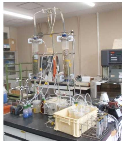
図 31 脱臭資材試験装置の概要（左：略図、右：装置写真）
