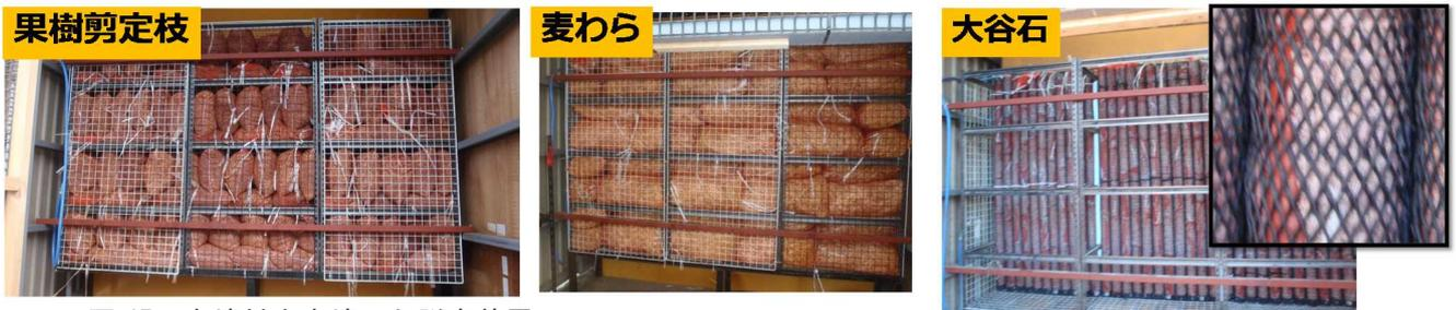
図 45 充填材を充填した脱臭装置
