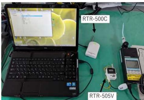
図1 臭気警報装置に使用した機材
