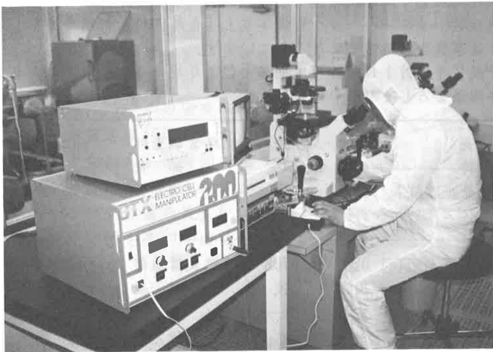
核移植に利用する細胞融合装置
