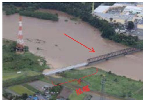
橋梁の架替により水位上昇を抑制
