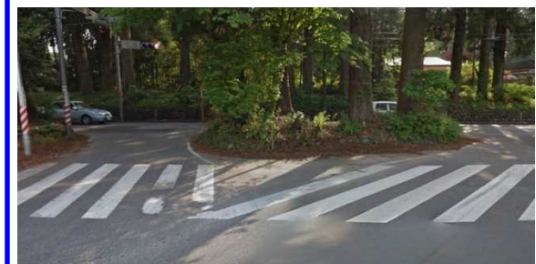
丁字路交差点内に並木杉があることから、交差点内の視認性が悪く極めて危険性が高い。
