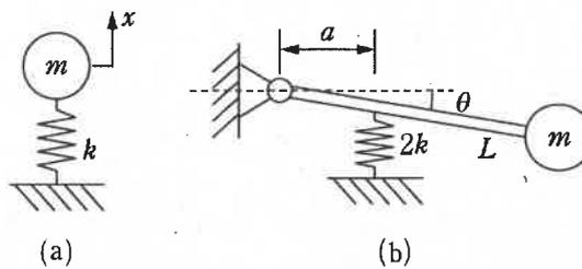
す片持ばり型振動系の固有円振動数が等価になるための片持ばり型振動系におけるばねの取付け位置の距離  $a$  はどのように表されるか。
