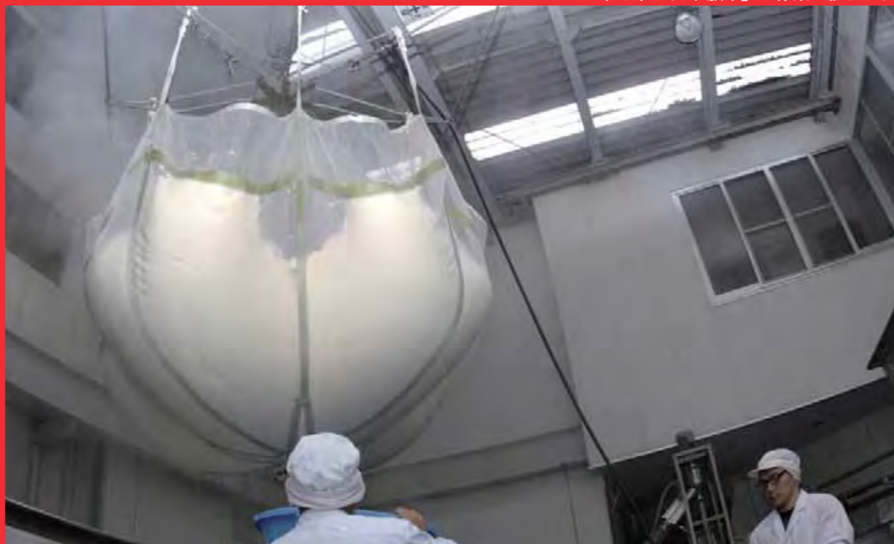
前日に洗米し、水に浸けた酒米を大きな釜で蒸しあげます。釜からは勢い良く湯気が立ち上がり、酒蔵は早朝から活気があふれます。これらの作業は「釜屋」と呼ばれる職人が担当します
