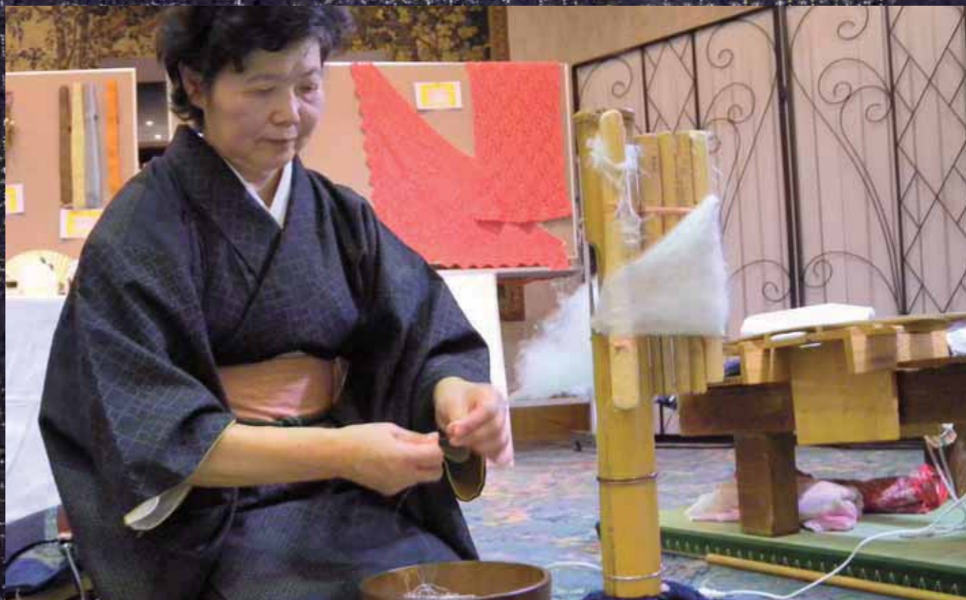
真綿（まわた）から糸を取る「糸つむぎ」の作業。つばをつけながらひねりを加え糸の太さを整える。撚りをかけないことで本場結城紬の独特の風合いが生まれる（伝統工芸士の山口美佐緒さん）
