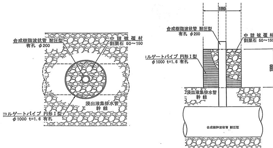
図 2.3.4-16 堅型ガス抜き管の構造図
