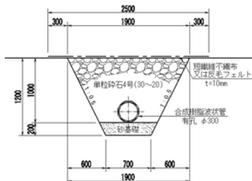
図 2.3.4-21 地下水集排水設備の構造
