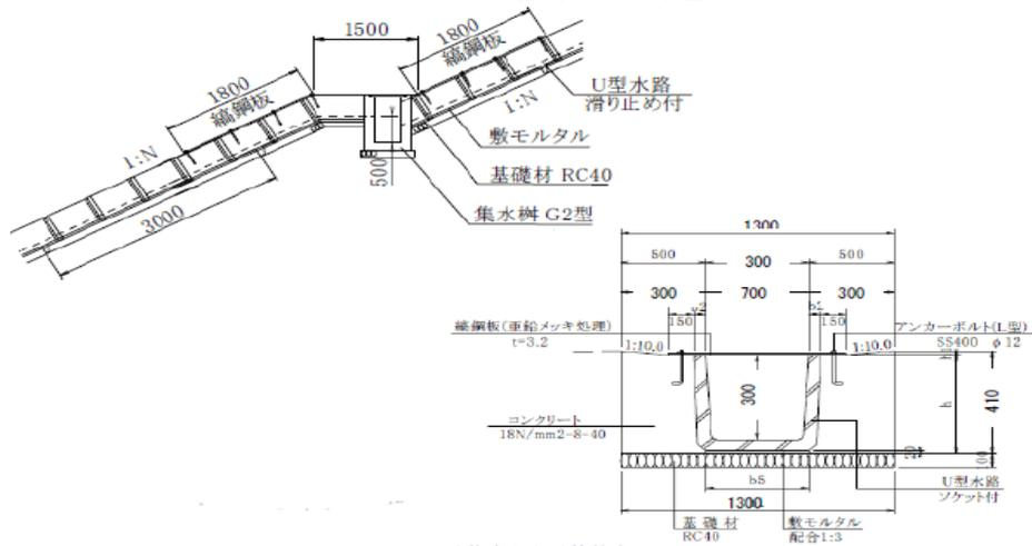
図 2.3.4-9 縦排水工の構造
