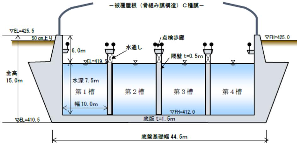
図 2.3.4-18 浸出水調整設備の横断面図
