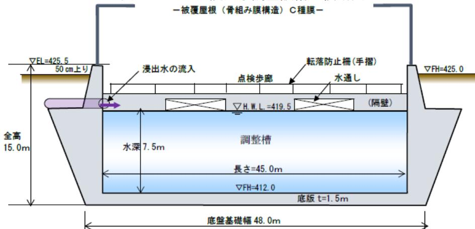
図 2.3.4-19 浸出水調整設備の縦断面図
