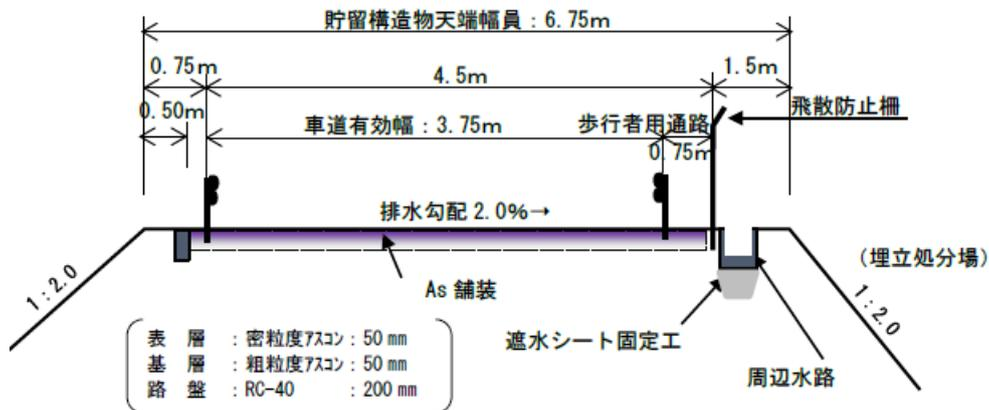
図 2. 3. 4-26(2) 貯留構造物天端走行部（土堰堤部）の搬入道路構造
