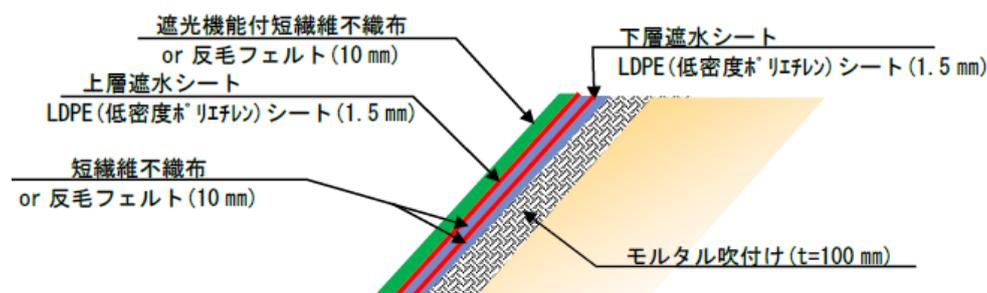
図 2.3.4-14 法面遮水工の構成図
