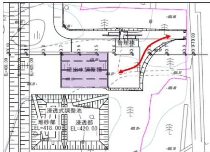
図 2.3.4-20 浸出水調整設備の配置図
