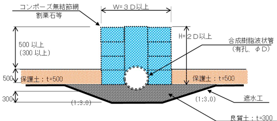
図 2.3.4-15 浸出水集排水施設・構造概念図
