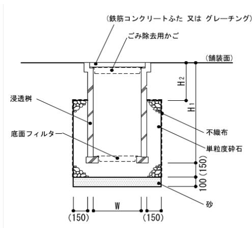
図 2.3.4-11 地中浸透式の集水柵構造
