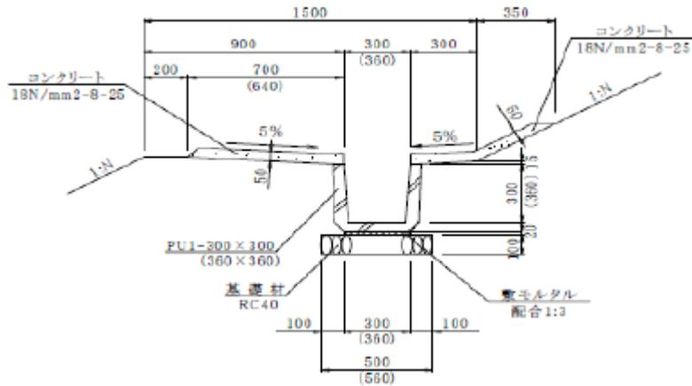
図 2.3.4-8 小段排水工の構造
