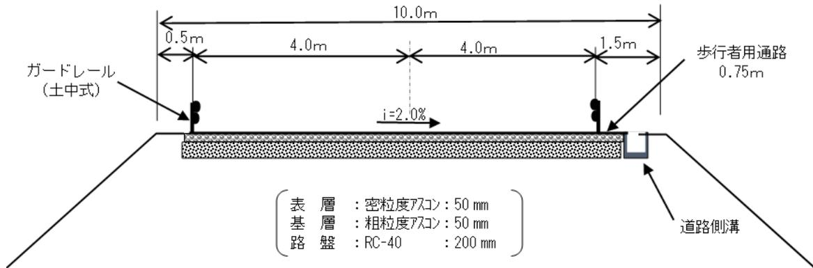
図 2. 3. 4-25 標準部の搬入道路構造
