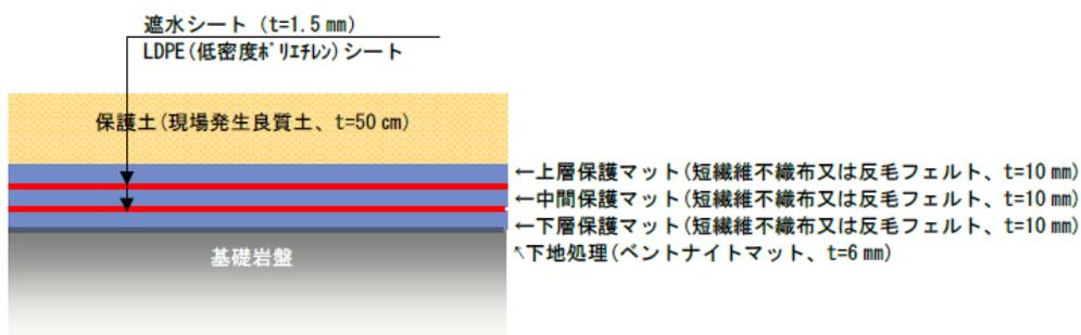
図 2.3.4-13 底盤遮水工の構成図
