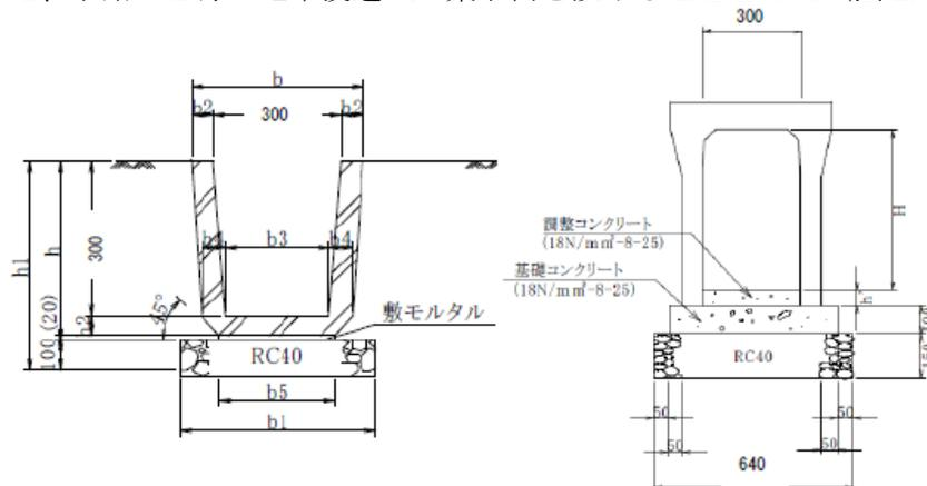
図 2.3.4-10 道路縦排水路の構造
