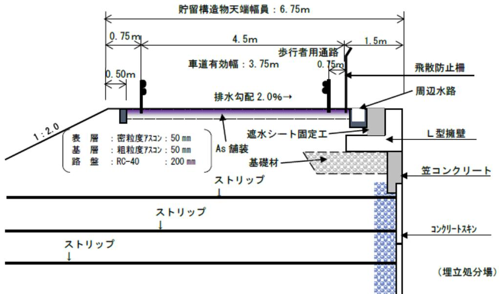
図 2. 3. 4-26(1) 貯留構造物天端走行部（テールアルメ部）の搬入道路構造
