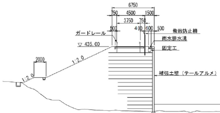
図 2.3.4-2 補強土壁構造（テールアルメ）
