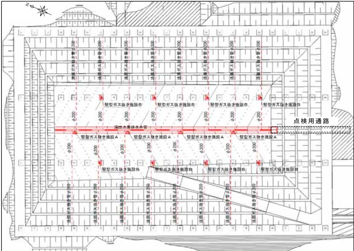
図 4-10-1 埋立ガス抜き施設計画平面図
