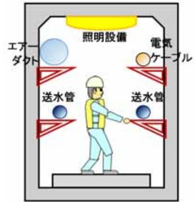
図 4-7-3 点検用通路概念図（断面図）
