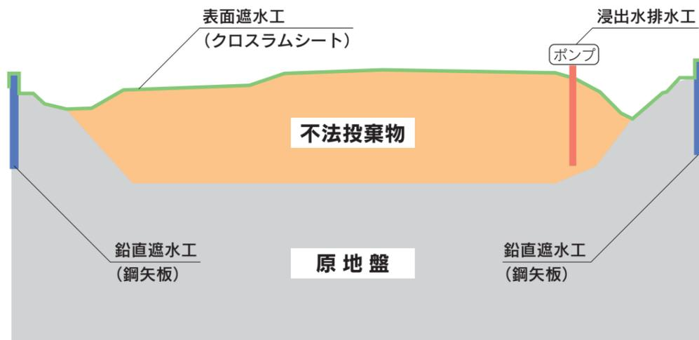
不法投棄地の外周を地下の岩盤まで鋼矢板を打ち込み、廃棄物に触れた水が流出しないように対策を講じています。
