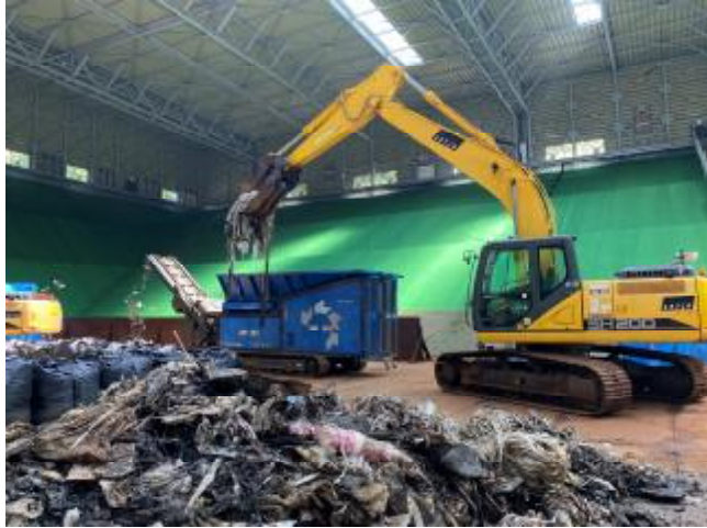
破碎機投入状況（廃プラスチック）
