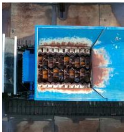
破碎機（不法投棄物を埋立するため細かくします）
