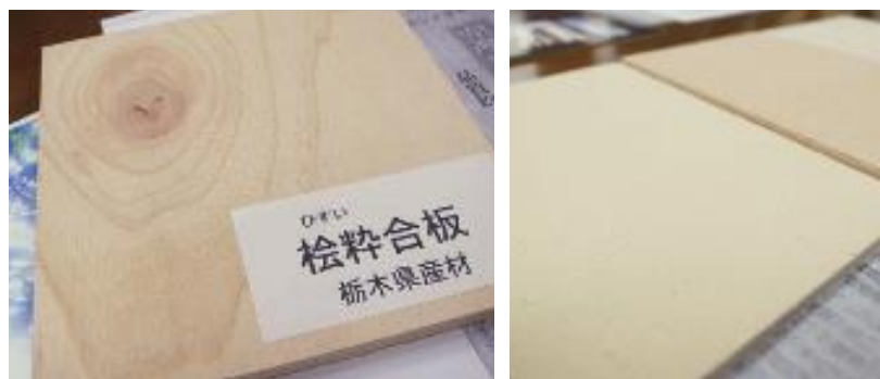
左：栃木県産のヒノキで作られた松粋合板。B材を使用することにより価格も抑えられ、売れ行きは好調 右：松粋を粉砕した松粋の塗り壁材。無垢材以外にもさまざまな用途展開が広がる
