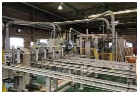
在来軸組工法ラインの例
