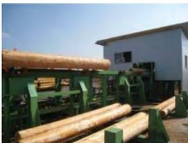
皮剥後、径級及び長さによって選別される
