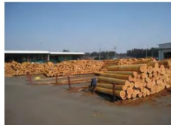
より効率化を図るため、皮剥前工程に径級及び長さによる選別がベスト
