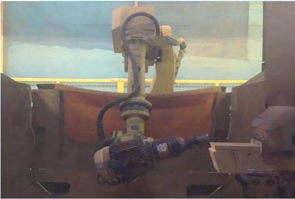
多関節ロボット 先端の刃物を自動で交換し加工していく
