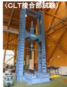
(鉛直構面の面内せん断試験)
