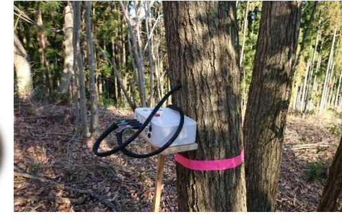
可搬型検査装置による立木の測定
