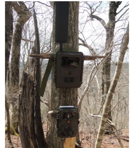
県東部のシカ低密度地域で、わなの見回りを軽減するリアルタイム画像の送信システム
