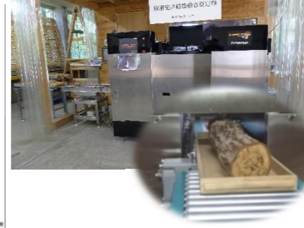
原木非破壊検査装置による原木測定
