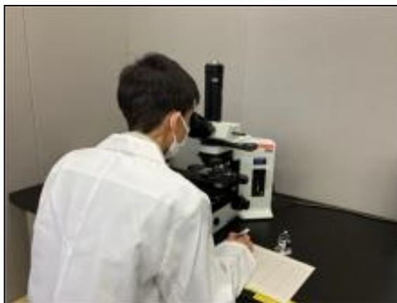
つか しら けんびきょうを使って、アスベストがあるかないかをしらべているようす
