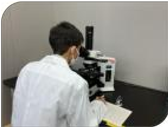
位相差顕微鏡による総繊維数濃度測定 （アスベスト大気環境調査）
