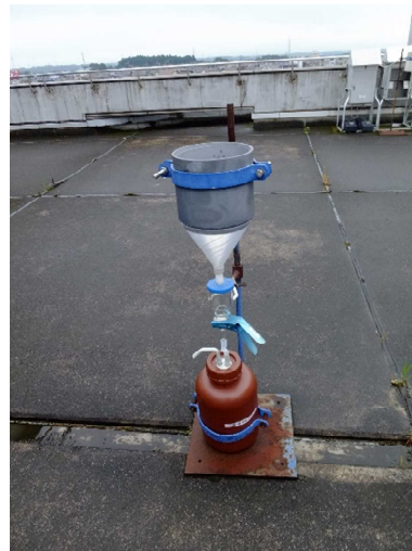
図1 ろ過式酸性雨採取装置
