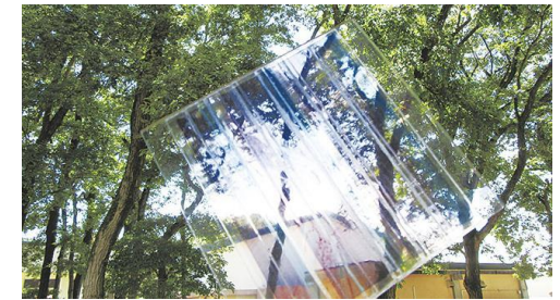
ガラス等に塗るだけで発電するインク
