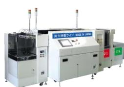
プリント基板用反り検査装置
