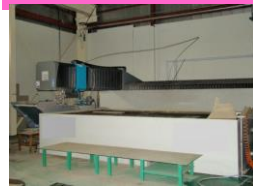
第2工場 大型ウォータージェット
