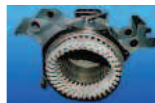
新幹線のぞみ用 VVVF300kw モータ
