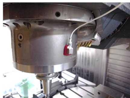
図3 加速度センサ主軸設置
