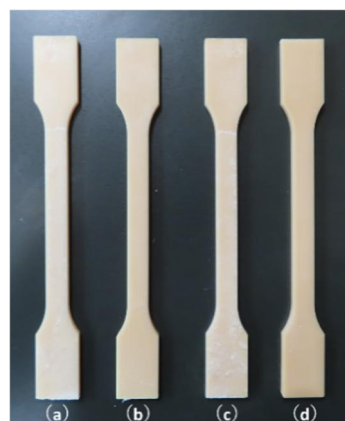
図 1 No.1 及び No.2 の射出成形品の外観写真 (a) No.1 v=10 mm/s、(b) No.1 v=100 mm/s、 (c) No.2 v=10 mm/s、(d) No.2 v=100 mm/s
