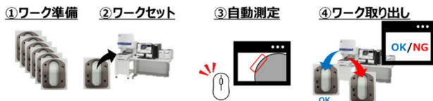
図5 手作業による検査工程の測定手順
