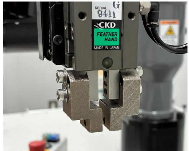
図8 検査工程用のロボットハンドのツメ
