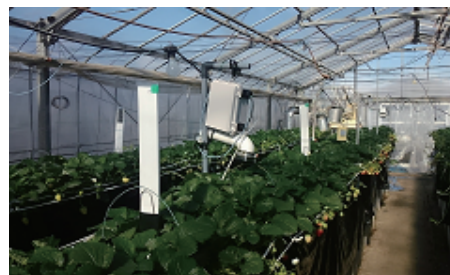
いちご研究所で試験中の自律型温室内環境制御システム
