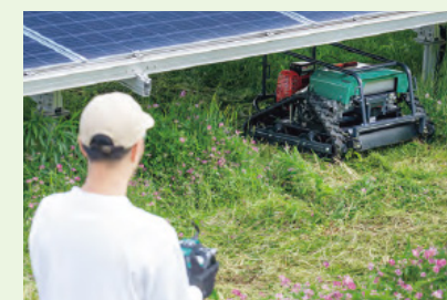
掲載機種の場合、傾斜45度対応。40度以上からランプ点滅、45度で警報音の角度センサーが作動
