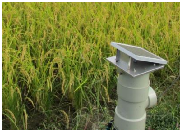
写真：とちぎの星のほ場に設置された自動給水装置
