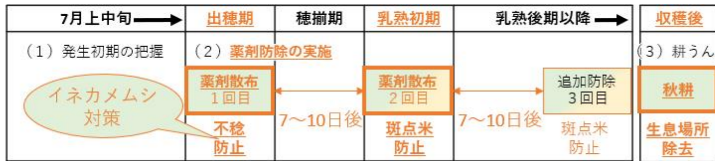
図 イネカメムシの発生地域における斑点米カメムシ類の総合防除体系
