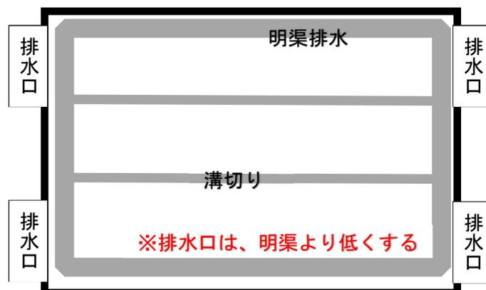
図10 明渠排水施工のイメージ
