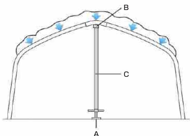
中柱による補強が有効で、天井部分の直管パイプを単管（C）等で支える補強方法です。
