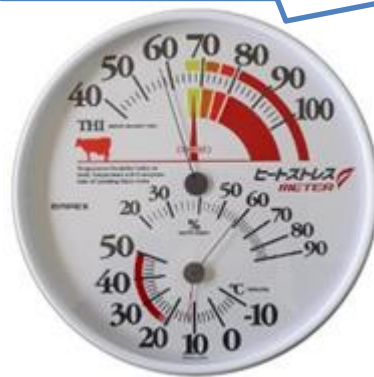
THIメーター
