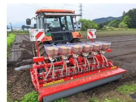
播種と鎮圧を同時に行う スリッローラーシーダーもある 播種条数12条 約320万円
