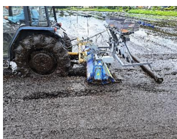
播種と鎮圧を同時に行う スリッローラーシーダーもある 播種条数12条 約320万円
