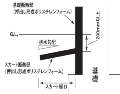
凍上現象のひどい地域の畜舎や堆肥舎でも、数多くの実験・検証の結果より、断熱材の地中埋め込み深さ200mm以上、スカート幅600mm程度のスカート断熱工法を採用することで、凍結深度の緩和が可能で、安価となります。
