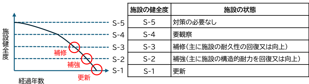
図4-6 健全度に基づく対策工事の考え方
