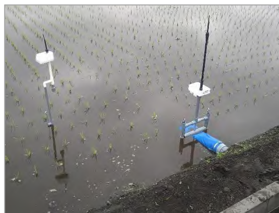
図 28 自動給水システム
