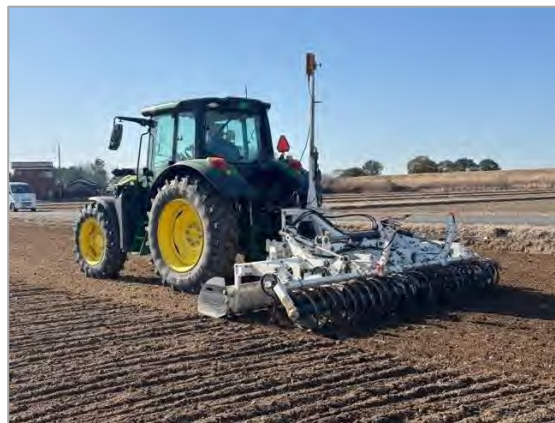
図 32 整地均平作業
