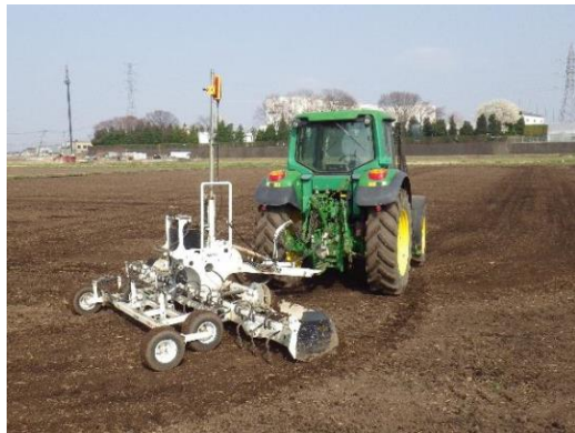
【レーザーレベラーを用いた農業者の直営施工】
