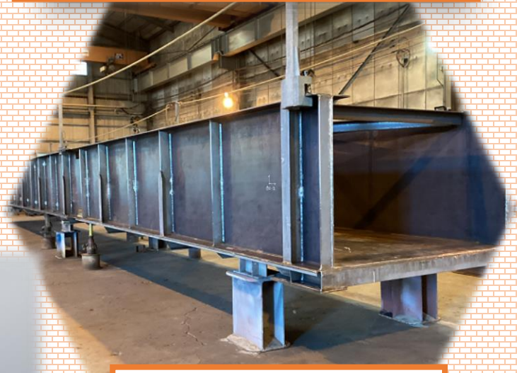
工場で製作した水路橋
