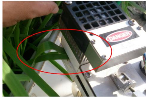
写真3 葉をチャンパー部に挟み光合成速度を測定
